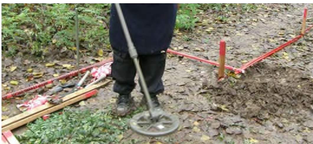
Figura 9 - Sopra esempio di metaldetector; sotto: impiego del metaldetector sul piano di campagna [figure tratte da cataloghi di aziende specializzate].
